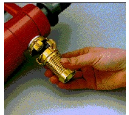
Saugtülle ankuppeln - bereit zum Trockenbohren
